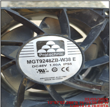
FOTO CORRIENTE SEGUN PLACA EN MOTOR VENTILADOR
