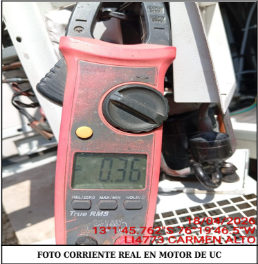
FOTO CORRIENTE REAL EN MOTOR DE UC
