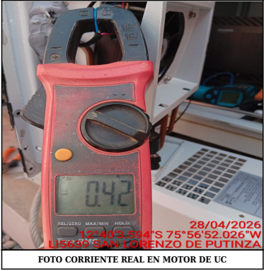
FOTO CORRIENTE REAL EN MOTOR DE UC
