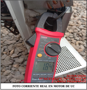
FOTO CORRIENTE REAL EN MOTOR DE UC
