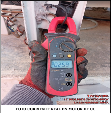
FOTO CORRIENTE REAL EN MOTOR DE UC
