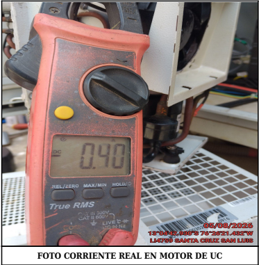
FOTO CORRIENTE REAL EN MOTOR DE UC
